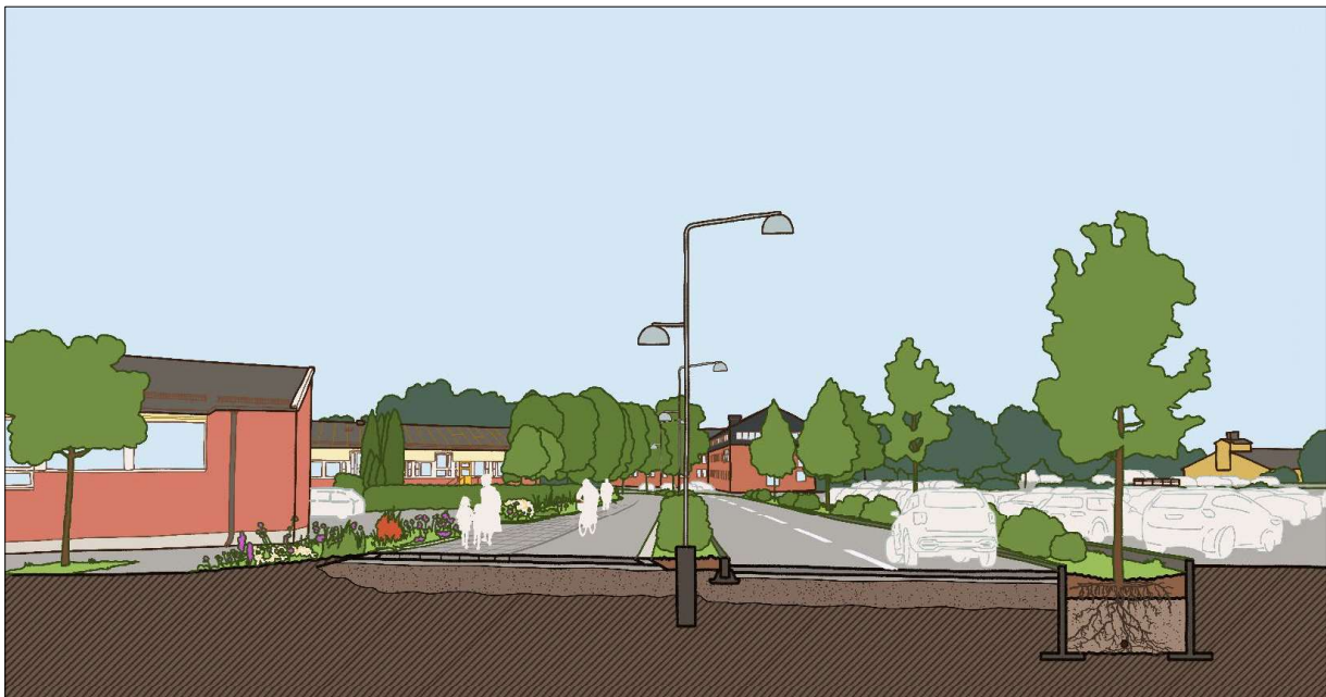
Figur 14. Illustrationen visar en sektion för den nya föreslagna Tappströmsvägen. Längst till höger i bilden syns den befintliga infartsparkeringen. Rakt fram syns Ekerö kommunhus och till vänster syns skolområdet. Mellan den nya körbanan och infartsparkeringen föreslås en grön gestaltad dagvattenanläggning som möjliggör för plantering av enkelsidig trädallé och mindre vegetation såsom exempelvis buskar. Mellan den nya körbanan och cykelbanan föreslås en möbleringszon för bland annat plantering av vegetation och placering av belysningsstolpar. Möbleringszonen är tänkt att även fungera som en fysisk separering mellan oskyddade trafikanter och motorfordon. För att förtydliga vilken yta som är avsedd för gående och cyklister föreslås gångbanan och cykelbanan ha olika beläggningar. Längst till vänster i bilden, mellan skolområdet och den nya gång- och cykelvägen föreslås plantering av ängsvegetation (en grön zon) för att skapa en mer inbjudande entré till skolorna.
