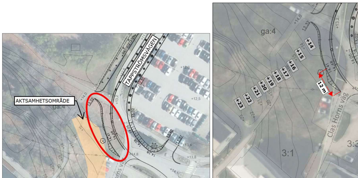
Figur 9. Vänster: Slänt i sydväst (inom den rödmarkerade området). Aktsamhetsområde markerat i orange. Höger: Totalt är det en sträcka på omkring 12 meter som påverkas och längden på släntpåverkan varierar längs med sträckan men är som längst 1,7 meter. Figurer hämtade från Geotekniskt utlåtande (AFRY, 2025-05-21).
